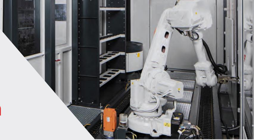
Starrag hat ein flexibles Fertigungssystem mit vier Bearbeitungszentren zur sicheren und kundenindividuellen Serienbearbeitung von Turbinenschaufeln entwickelt und lebt damit den Grundgedanken von Industrie 4.0.
