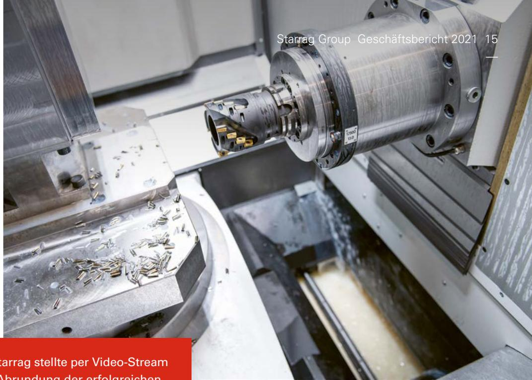
Virtuell hochdynamisch: Starrag stellte per Video-Stream die Heckert H65 vor, eine Abrundung der erfolgreichen Heckert-4-Achs-Horizontal-Bearbeitungszentren nach oben. Der Neuzugang kann bei kompakter Bauweise bis zu 1,5 Tonnen schwere Werkstücke bearbeiten.
