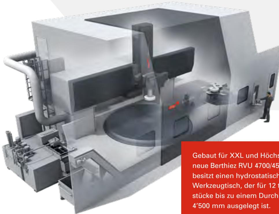
Gebaut für XXL und Höchstpräzision: Das neue Berthiez RVU 4700/450 Schleifzentrum besitzt einen hydrostatisch gelagerten Werkzeuggestisch, der für 12 t schwere Werkstücke bis zu einem Durchmesser von 4'500 mm ausgelegt ist.
