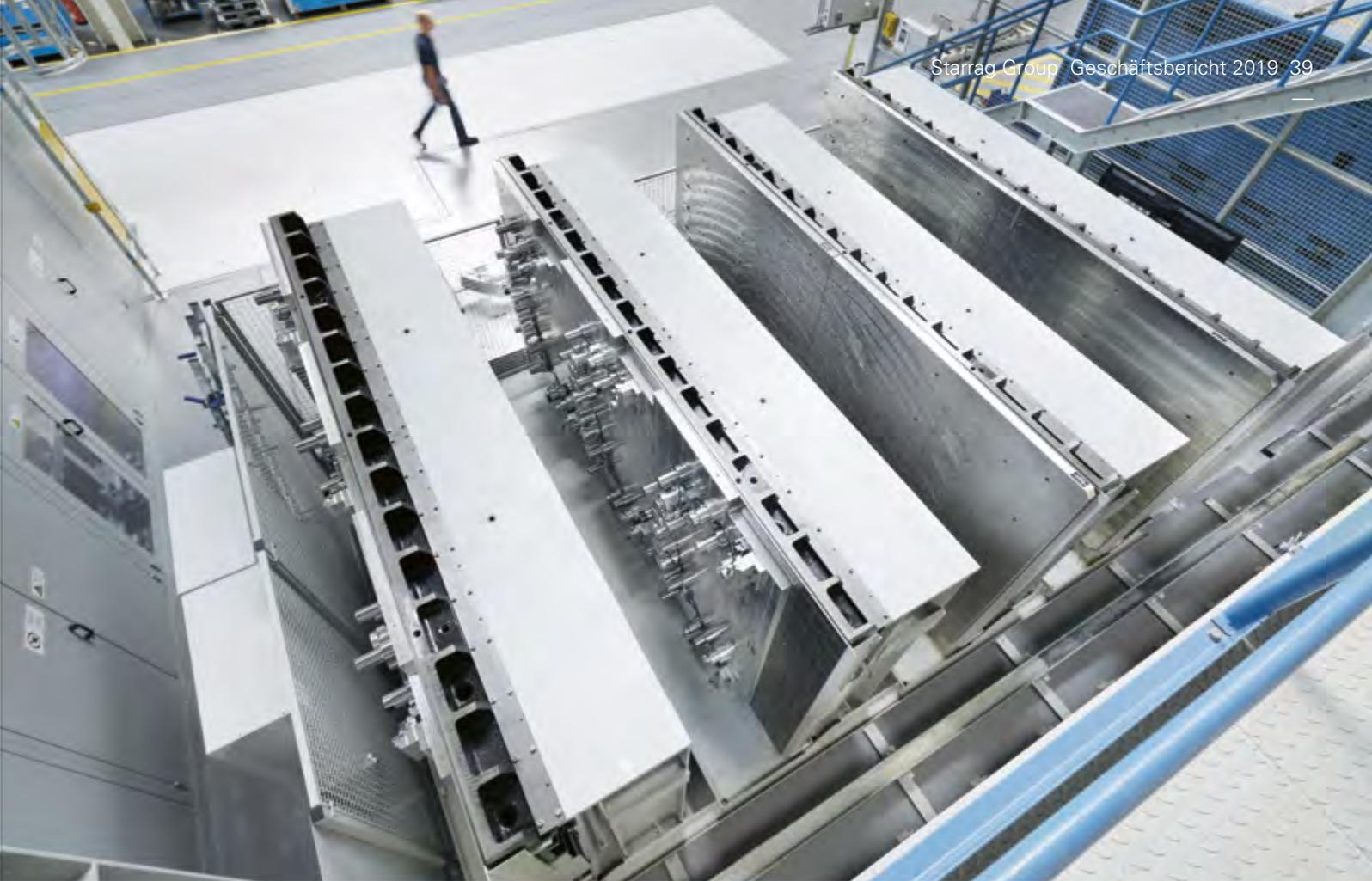
**Logistik:** Ein Transportsystem mit Doppelbeladewagen übernimmt im Hintergrund das Werkstückhandling.
