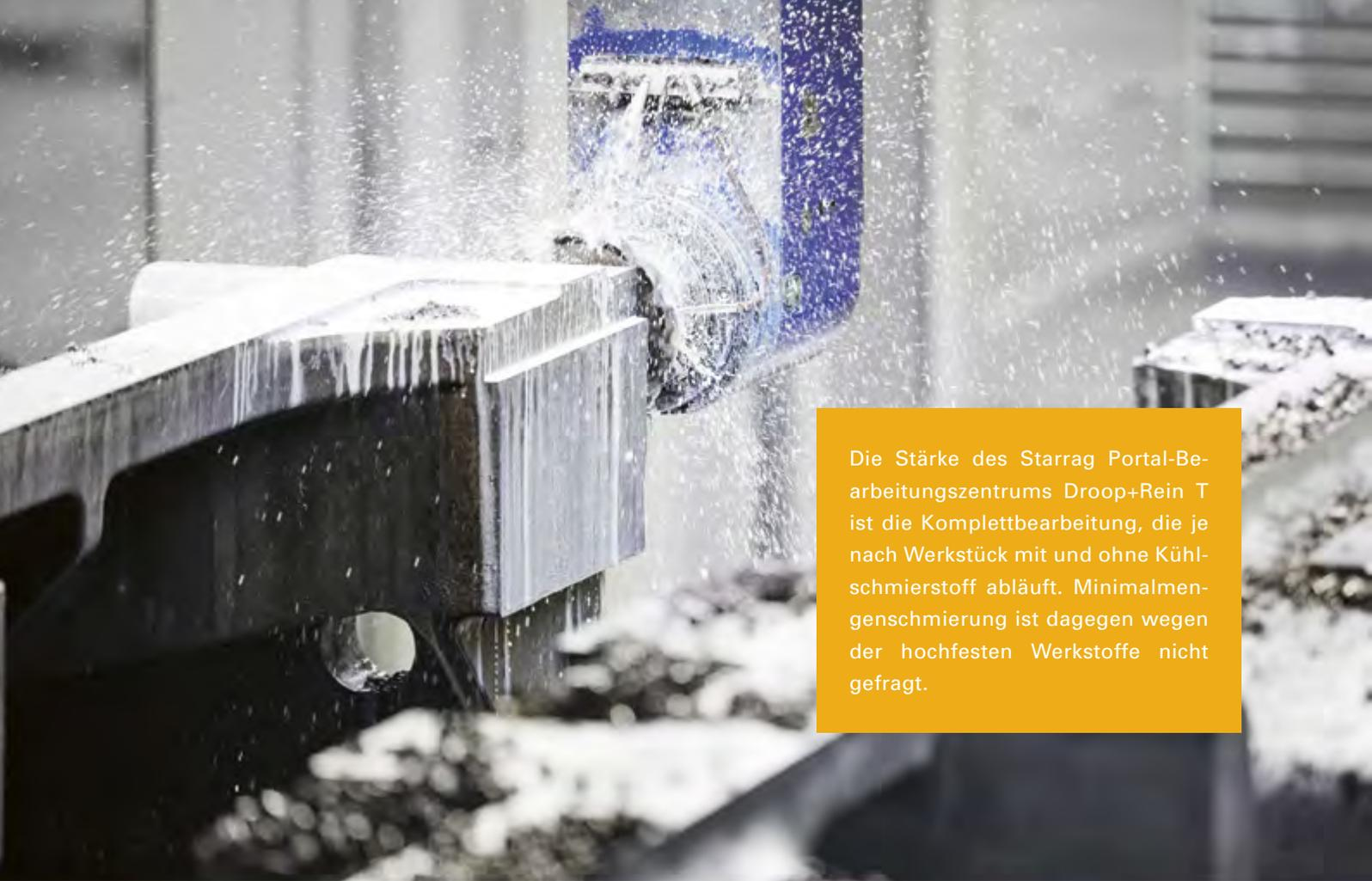
Die Stärke des Starrag Portal-Bearbeitungszentrums Droop+Rein T ist die Komplettbearbeitung, die je nach Werkstück mit und ohne Kühlschmierstoff abläuft. Minimalmengenschmierung ist dagegen wegen der hochfesten Werkstoffe nicht gefragt.
